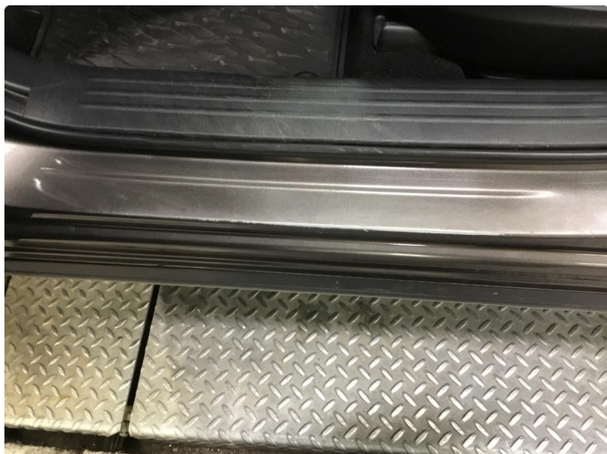
1.3 Slitasje på innsteg
