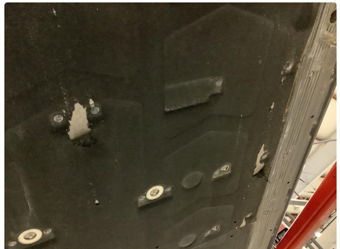
1.2 Beskyttelsesplate under bil er skadet
