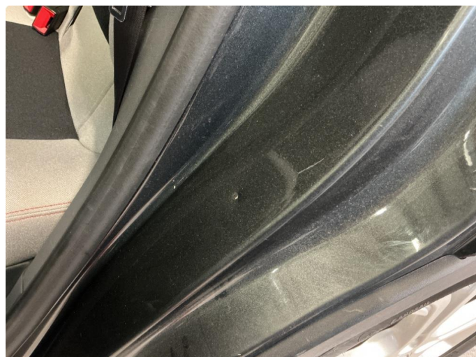
1.2 Bulk(er) med lakkskade
