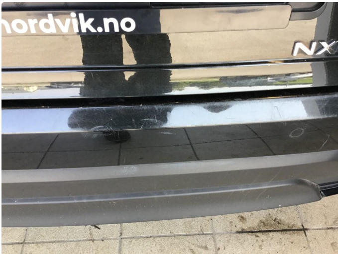
1.1 Noen riper ved bagasjeluke
