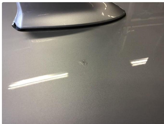
1.6 Steinsprut med rust
