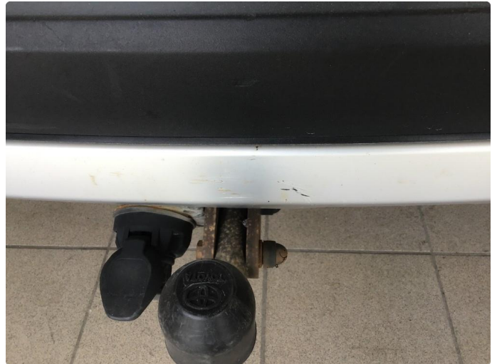
1.1 Noe riper og slitasje på bakfanger
