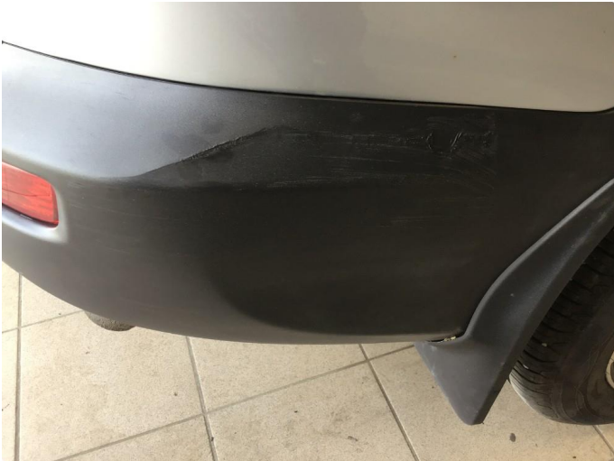
1.1 Noe riper og slitasje på bakfanger
