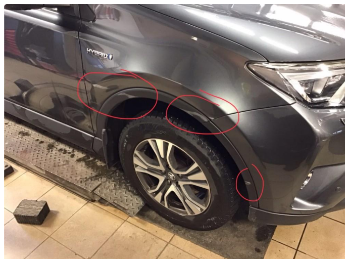
1.1 Diverse riper, er behandlet med polering og plastikkforny
