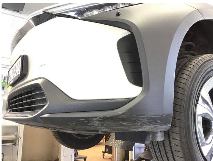
1.2 Riper på plastikk framfanger, begge sider.
