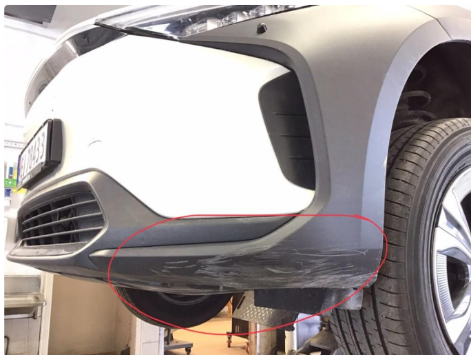
1.2 Riper på plastikk framfanger, begge sider.
