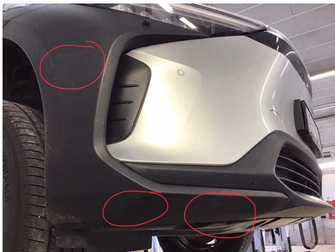
1.2 Riper på plastikk framfanger, begge sider.
