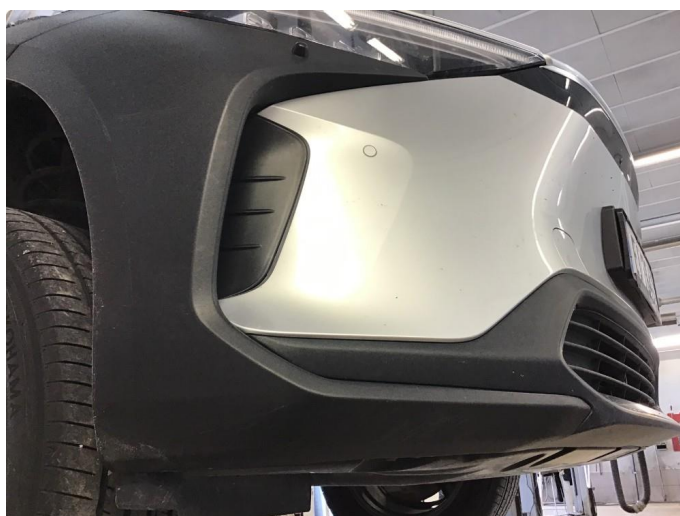
1.2 Riper på plastikk framfanger, begge sider.
