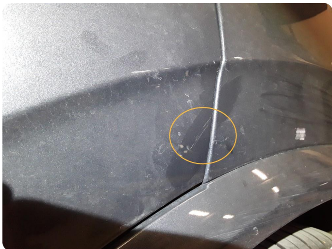
2.2 Ripe ned til grunning
