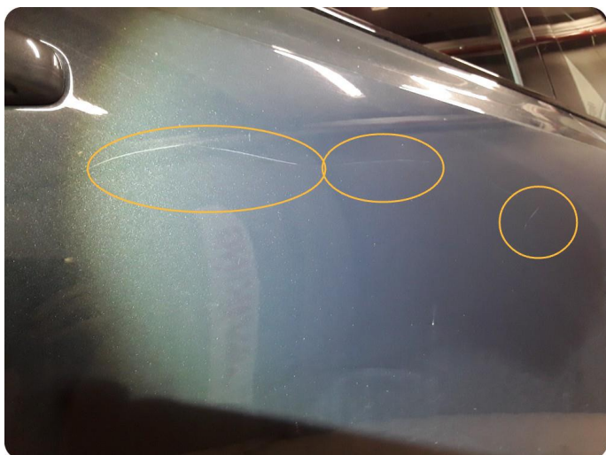
2.3 Ripe ned til grunning
