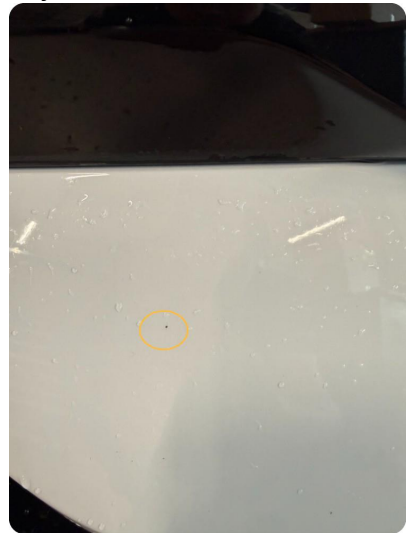
1.2 Steinsprut Normal slitasje - flekke
