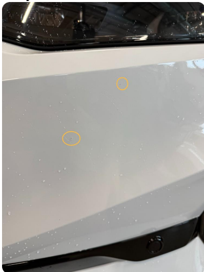
1.2 Steinsprut Normal slitasje - flekke
