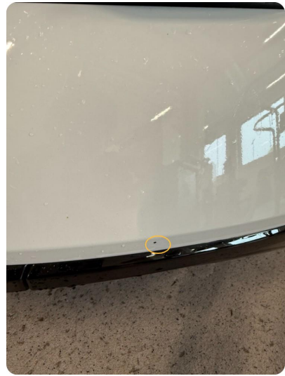
1.2 Steinsprut Normal slitasje - flekke
