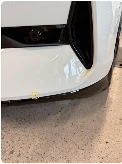
1.2 Steinsprut Normal slitasje - flekke
