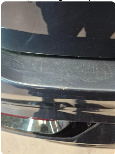
1.2 Ripe(r) ned til grunning Diverse småskader bak på fanger i innsteg til bakluke. Anbefaler beskyttelsesfolie/støtfangerbeskyttelse bak
