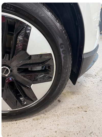
1.2 Kantkjørt felg Diamond Cut Unormal slitasje
