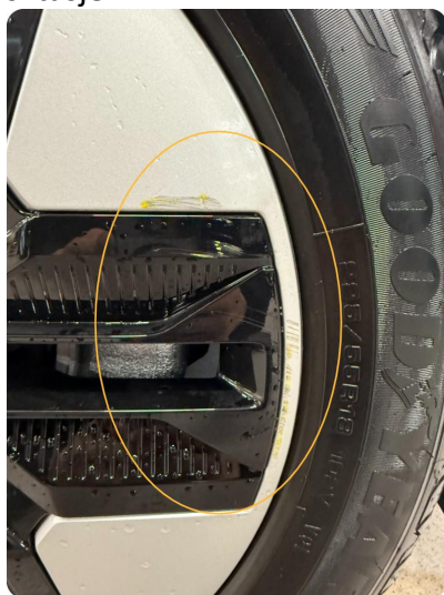
1.2 Kantkjørt felg Diamond Cut Unormal slitasje
