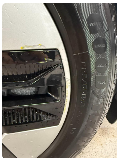
1.2 Kantkjørt felg Diamond Cut Unormal slitasje
