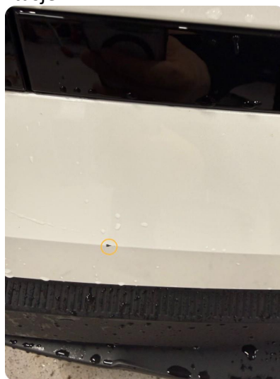
1.3 Steinsprut Normal slitasje - flekke
