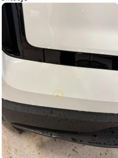
1.3 Steinsprut Normal slitasje - flekke
