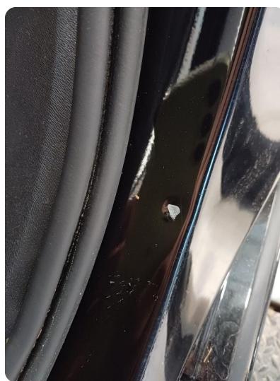
1.1 Bulk(er) med lakkskade
