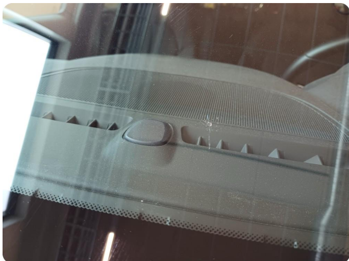
1.2 Steinsprut med sprekk Ca pris
