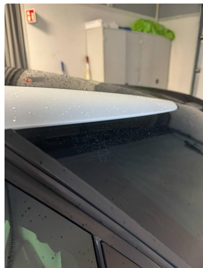
1.5 Noe slitasje i h.bakvindu. Oppstått ved skifte fra kulde til varme. Har ingen påvirkning.
