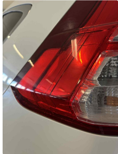
1.2 Noe sprekk i begge baklykter. Lykter tett, påvirker ikke lyktene. Kjent på Honda
