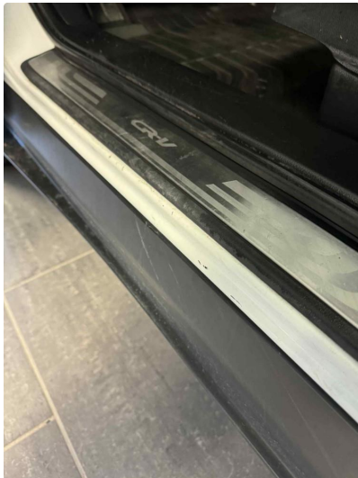
1.3 Mindre slitasje i førerdør åpning
