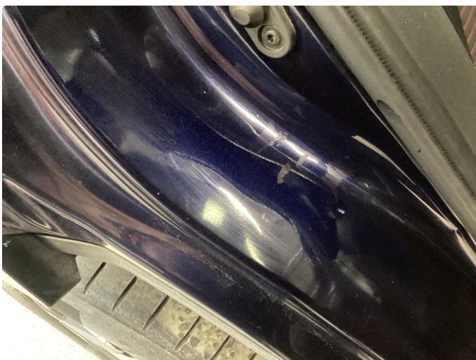
1.2 Småbulker - Grunnet setebelte. Normal slitasje
