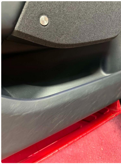
2.1 Lett slitasje førerdør, grunnet innsteg. Normal iht alder og km
