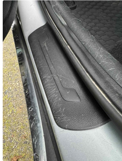
1.2 Noe slitasje i døråpning Normalt iht alder og km
