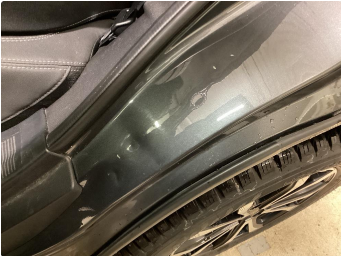
1.1 Mindre merke etter sikkerhetsbelte - Normal bruksslitasje
