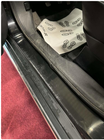
2.1 En del bruksslitasje i innsteg foran og bak
