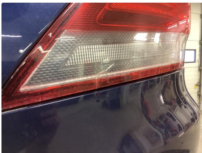
2.1 Noe sprekk i begge baklykter. Lykter tett, påvirker ikke lyktene. Kjen WAG situasjon
