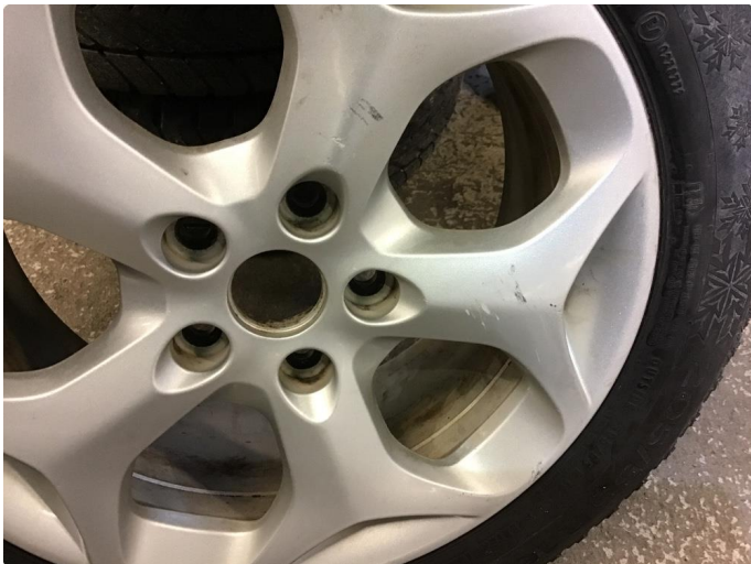
1.3 Normal bruksslitasje i felger
