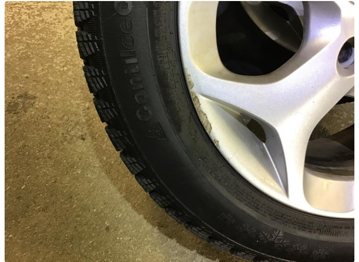
1.3 Normal bruksslitasje i felger
