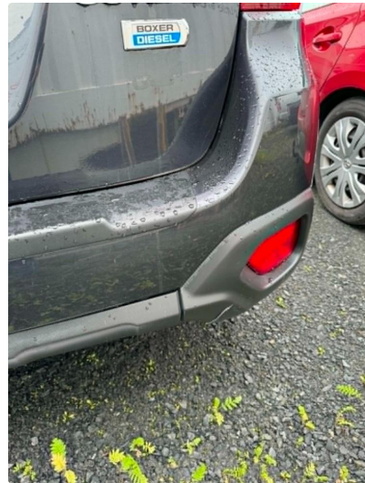
1.2 Liten sprekk i bakfanger
