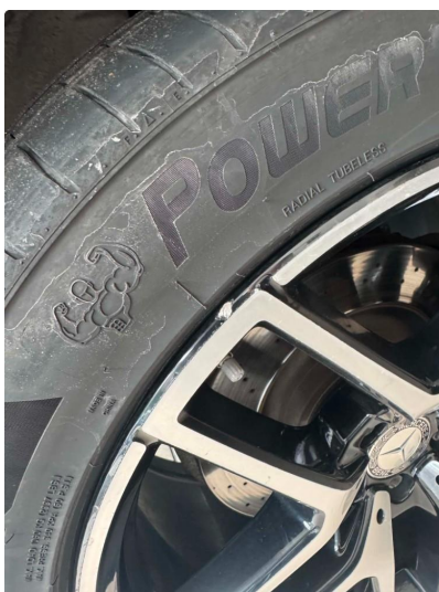
1.2 Noe bruksslitasje på sommerfelger
