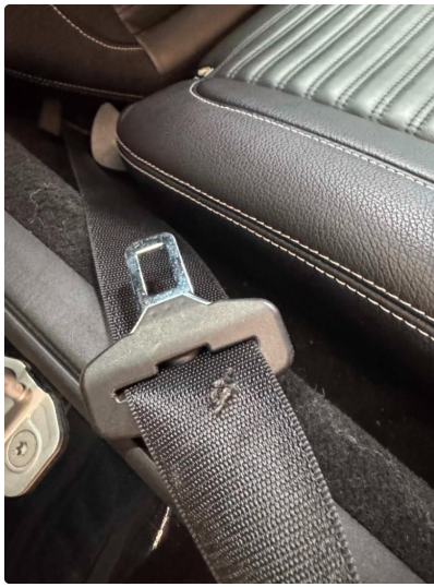
2.1 Noe bruksslitajse på føresete og belte h.bak
