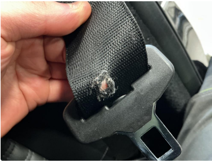
2.2 Skade på belte
