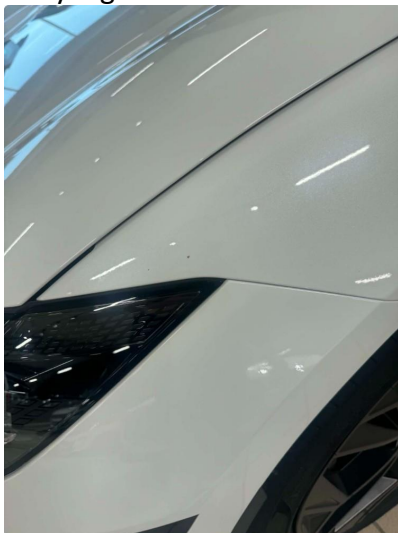
1.1 Noe mindre strinsprut Nesten ikke synlig
