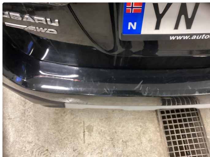
1.1 Normal bruksslitasje iht. alder / km.
