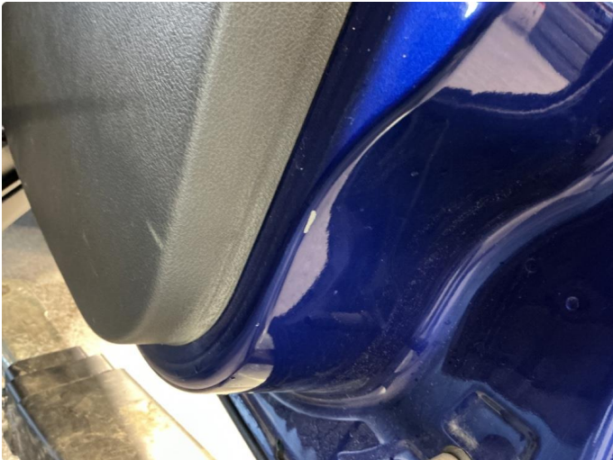
1.1 Noe slitasje i innlasting
