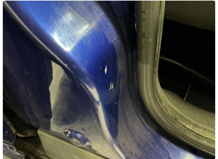
1.1 Noe slitasje i innlasting
