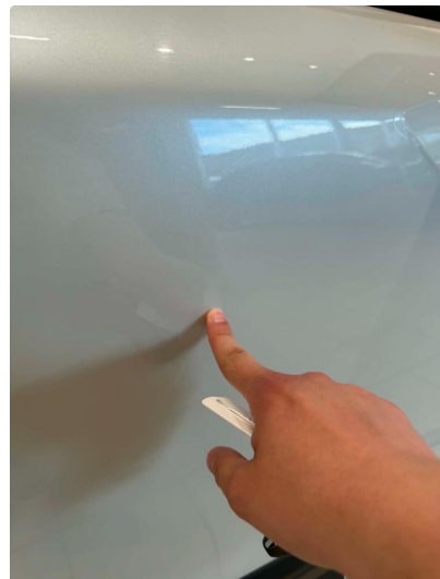
1.2 2 små bulker på dør. Nesten ikke synlig
