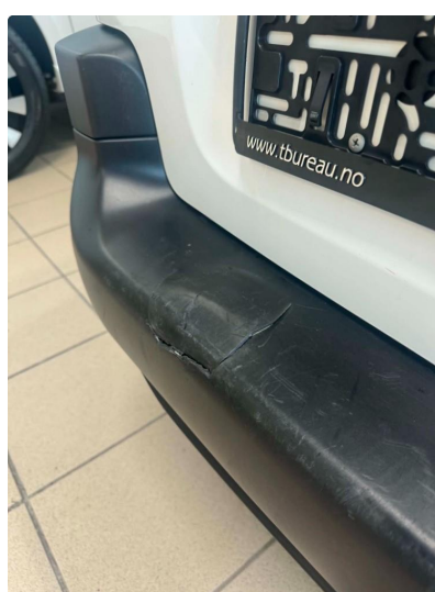
1.4 Liten p-skade på bakfanger, og lett slitasje
