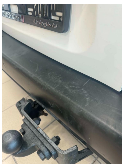
1.4 Liten p-skade på bakfanger, og lett slitasje
