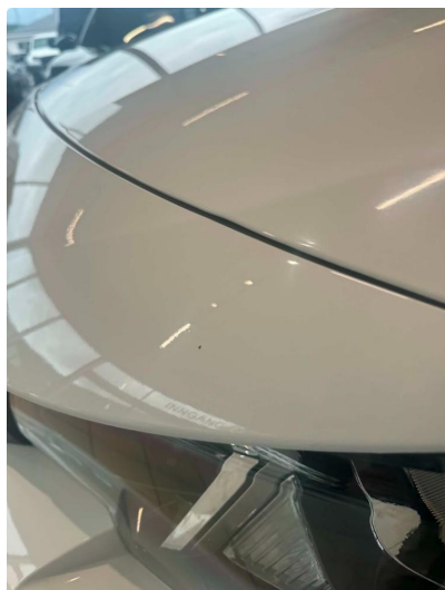
1.1 Noe steinsprut i lakk - Normal slitasje
