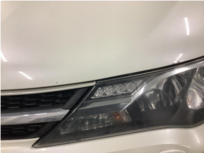
1.2 Steinsprut, ikke rust, kan pensles
