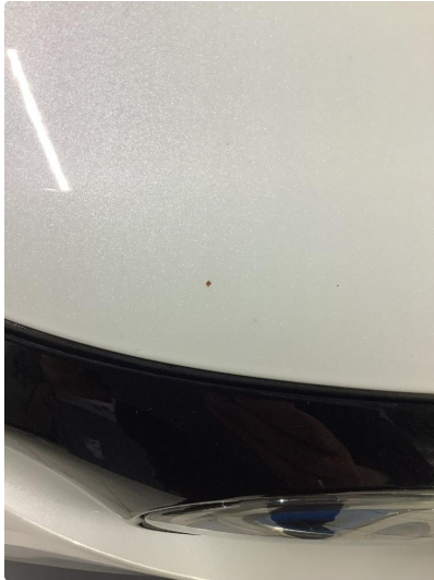
1.1 Panseret har noen steinsprut. Normal bruksslitasje.
