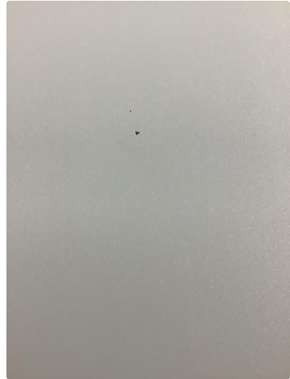
1.1 Panseret har noen steinsprut. Normal bruksslitasje.
