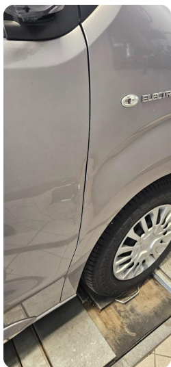
1.1 Skade Skade høyre fordør og forskjerm. Egen skadetakst ref Jon.
