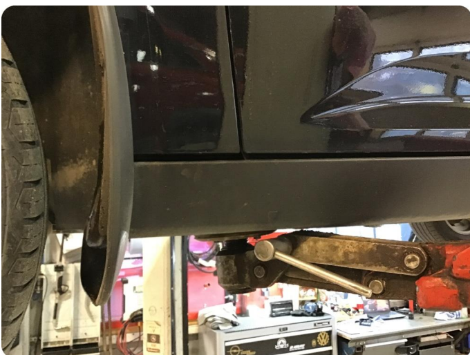
1.3 Øvrige feil Kanal skjørt og skvettlapp løs og en liten skade
