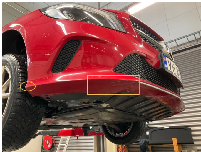
1.4 Ripe(r) ned til grunning
