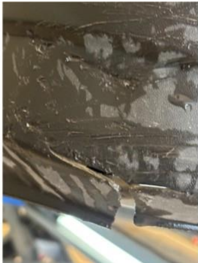
1.2 Liten sprekk i støtfanger bak, plast
