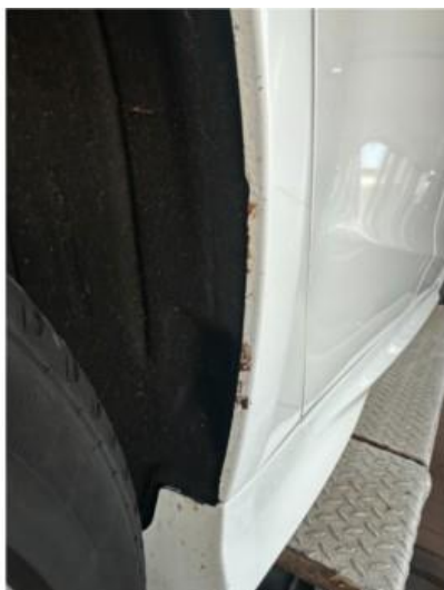
1.2 Noe rust på bakskjermer
