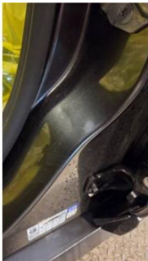
1.2 Bulk i døråpning på førerdør
