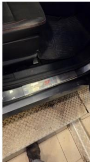
1.3 Liten bulk i sparkeplate høyre side foran
