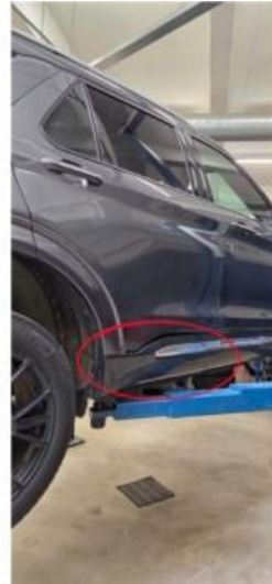
1.2 Noe løs list under høyre bakdør
