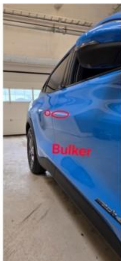
1.1 Tre små bulker på dører, høyre side
