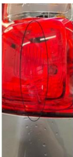
2.2 Sprekk i høyre baklykt
