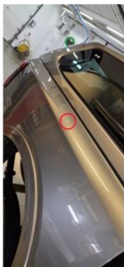
1.3 Liten bulk med lakkskade på høyre bakskjerm
