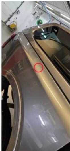
1.3 Liten bulk med lakkskade på høyre bakskjerm
