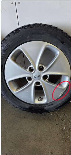
1.2 En kantkjørt vinterfelg, noe korrosjon på disse.
