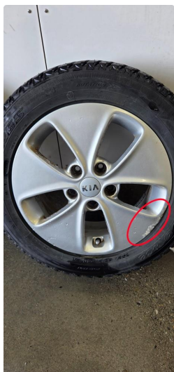
1.2 En kantkjørt vinterfelg, noe korrosjon på disse.
