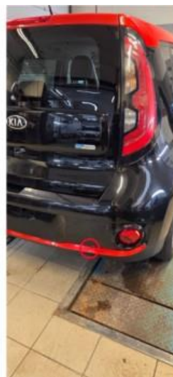
1.3 Liten lakkskade på støtfanger bak
