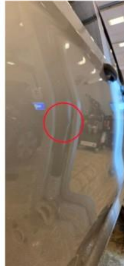
1.2 Liten bulk på høyre skyvedør
