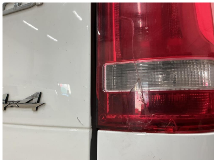
2.1 Defekt / sprukket glass
