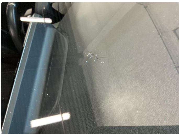
1.1 Steinsprut med sprekk
