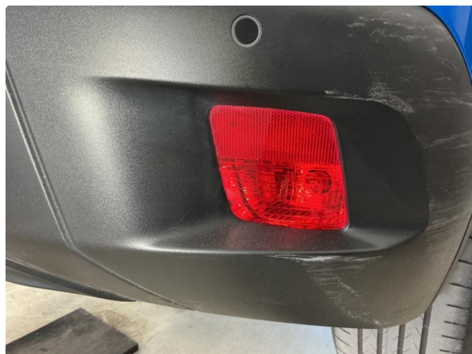
2.1 Tåkelys - defekt/sprukket glass
